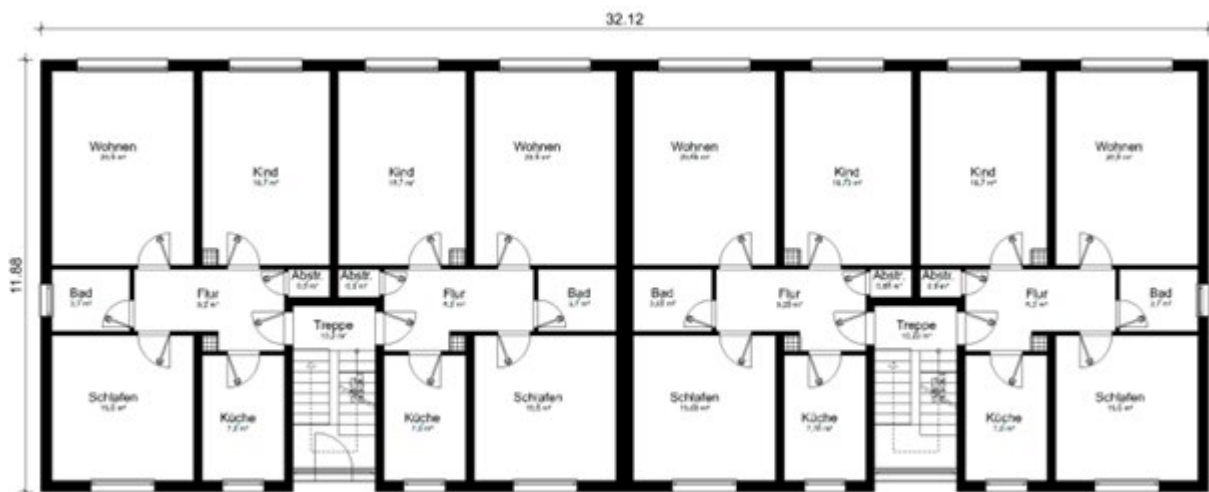
Abb. 37: Isometrie und Grundriss des untersuchten Referenzgebäudes, Heizlast des Gebäudes mithilfe einer thermischen Gebäudesimulation ermittelt (TRNSYS); für die Trinkwarmwasserzapfungen wurden dynamische Lastprofile über das Simulationstool „synPro“ des Fraunhofer ISE erstellt
