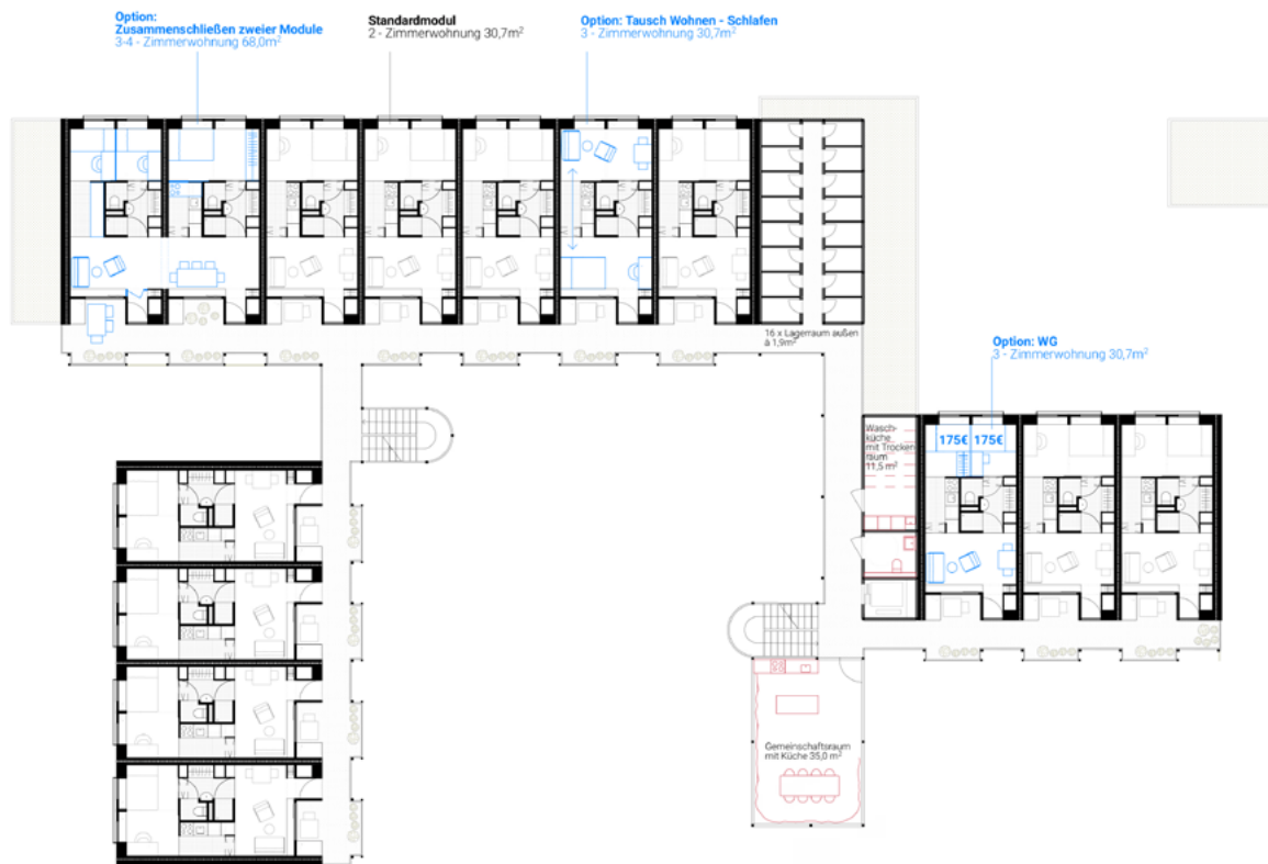
Abb. 3: Regelgeschoss mit Wohnungen (inkl. Variationen), Lagerräumen, Gemeinschaftsraum und Waschküche mit Trockenraum, erschlossen über Laubengang mit den Freisitzen vor der Wohnungstür als Wettbewerbsbeitrag von studio blau sieben .
